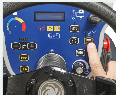
Le plateau brossier/l'embouchure descendent automatiquement, réduisant ainsi les efforts de l'opérateur
