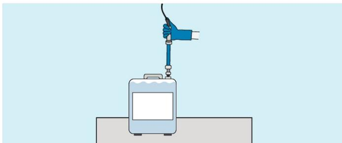
4. Raccordez le produit au système de dosage de blanchisserie avec des conduits d'aspiration appropriés.
