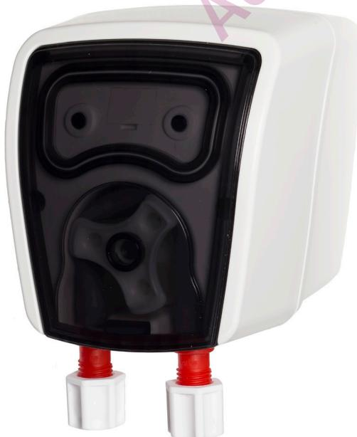
Le Quantura 10 est un système composé d'une pompe péristaltique, prévu pour le dosage d'un seul produit chimique pour les lave-verres ou les lave-vaisselles encastrables. L'appareil peut être utilisé pour le détergent liquide ou le produit de rinçage.
